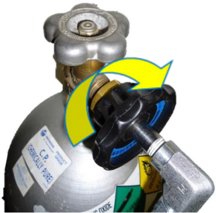
Figur 5: Fest den svarte bryteren i den gjengede koblingen
