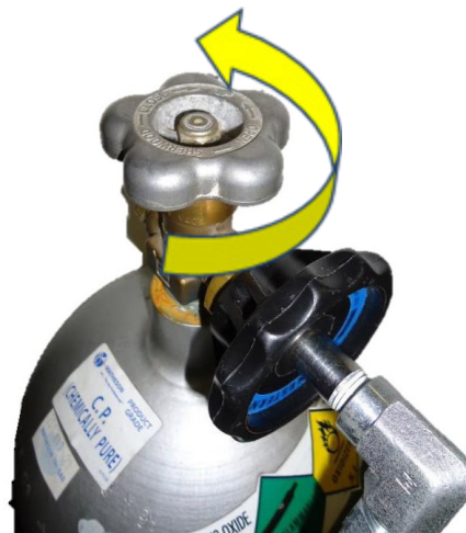
Figur 6: Vri ventilen mot klokka for å åpne
