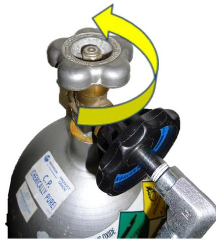
Figura 6: Rode a válvula no sentido contrário ao dos ponteiros do relógio para abrir
