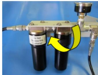
Figura 23: Remoção do compartimento de filtro
