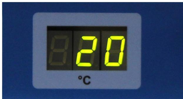
*Figura 16: Ecrã de temperatura de sonda*
