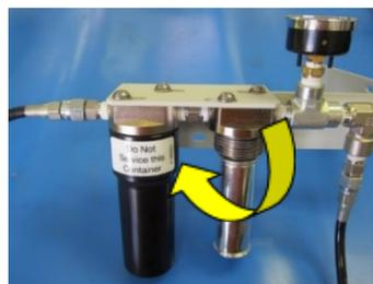
Figura 24: Remoção do cartucho de filtro dessecante
