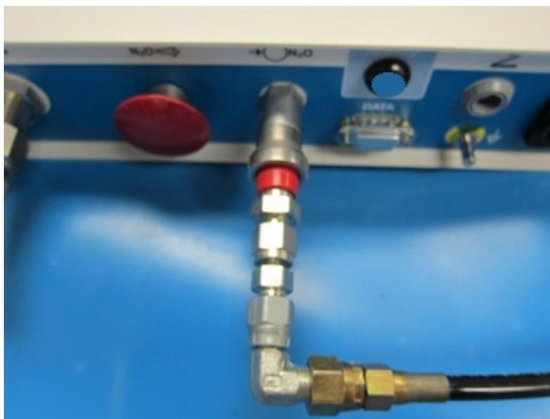
Figura 4: Ligação de entrada de N<sub>2</sub>O
