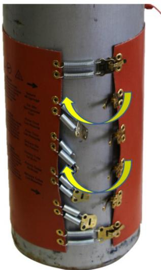
Figura 8: Asegure todos los retenedores del muelle de tensión
