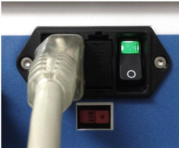
Figura 10: Encendido de la AtriCure cryoICE BOX con el interruptor
