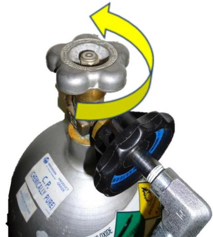
Figura 6: Gire la válvula en sentido contrario a las agujas del reloj para abrir
