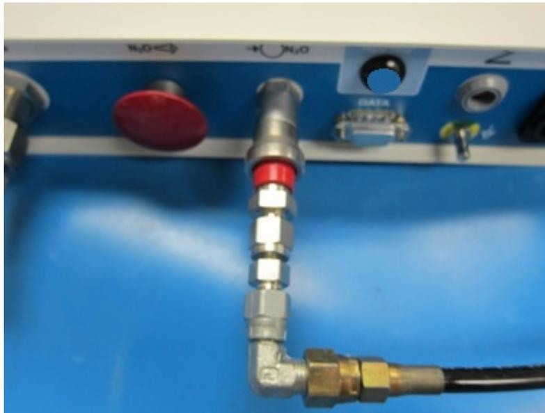
Figura 4: Conexión de entrada de N<sub>2</sub>O
