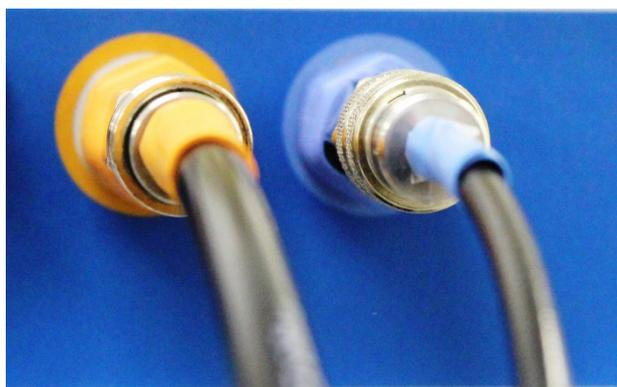
*Figura 13: Conectores neumáticos con código de colores*
