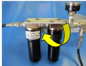
Figura 23: Extracción del armazón del filtro
