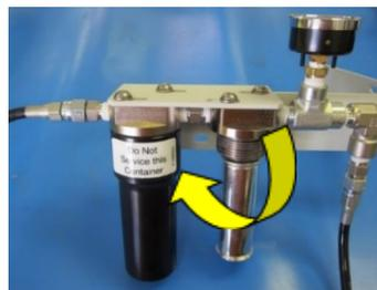
Figura 24: Extracción del cartucho del filtro desecante
