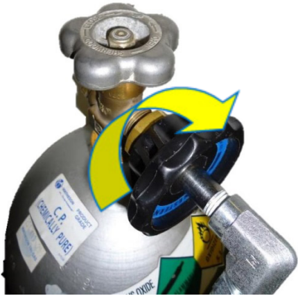
Figur 5: Fäst det svarta vredet på den gängade anslutningen
