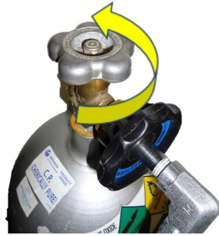
Şekil 6: Valfi Saat Yönünün Tersine Çevirerek Açın
