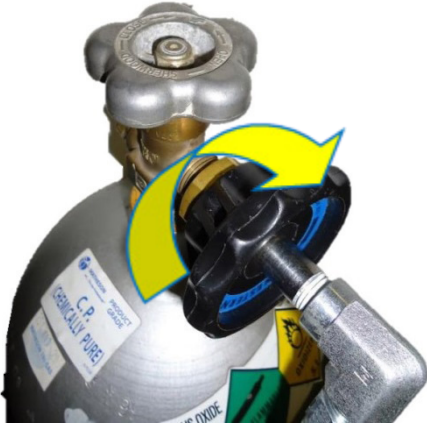
Şekil 5: Siyah Düğmeyi Dişli Bağlantıya Takın
