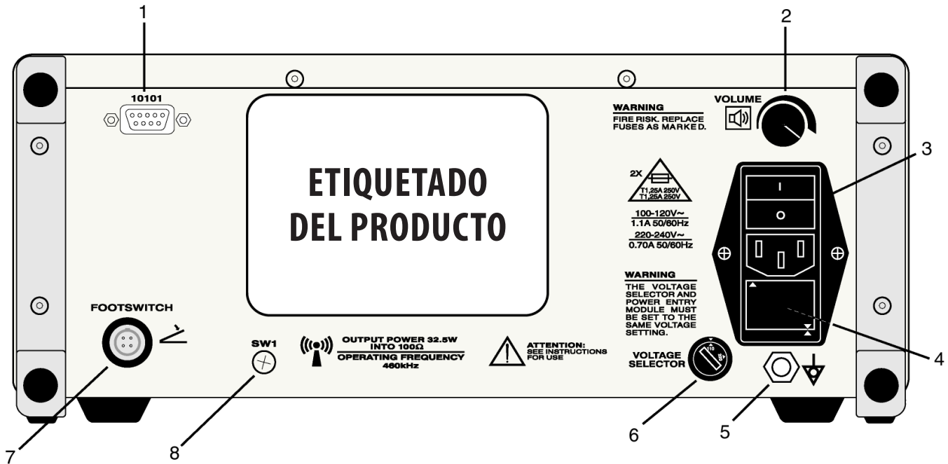
Figura 3: panel posterior de la ASU
